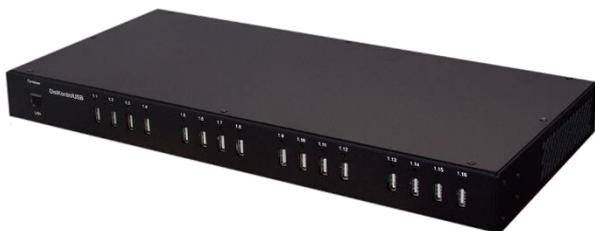
Управляемый USB over IP концентратор
