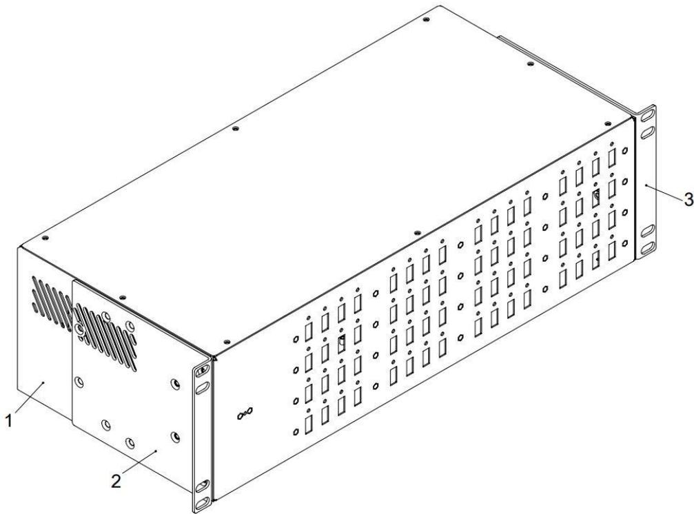
Сборка устройства для крепления в стойку 19".
