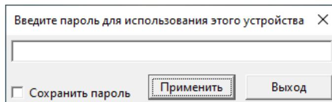
При правильном вводе пароля устройство USB будет подключено к компьютеру пользователя и до перезапуска клиента. Ввод пароля больше не потребуется даже при отключении и повторном подключении к устройству.
