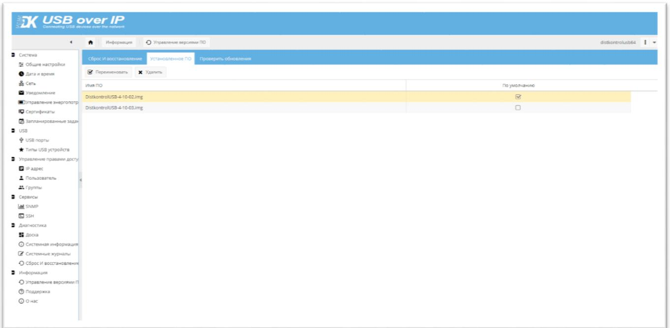
При обновлении на новую версию ПО концентратора, предыдущая версия ПО будет доступна в данной вкладке и, при желании, на неё возможно откатиться, нажав на соответствующий чек-бокс.
