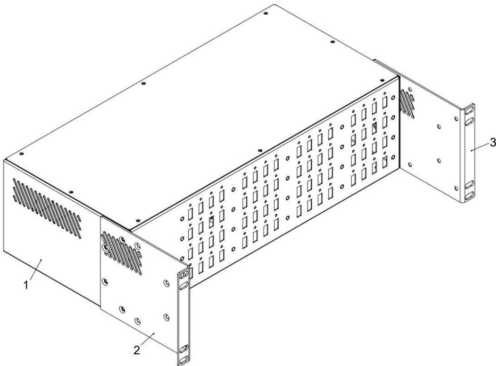
Сборка устройства для крепления в шкаф 19".
