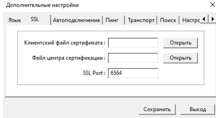
После настройки, клиент автоматически подключается к управляемому USB over IP концентратору с использованием TLSv1.2 через порт SSL по умолчанию 6564. Если вы не используете «Автоматический поиск», вам необходимо в меню «Specify Hubs» ввести адрес управляемого USB over IP концентратора и указать порт 6564.
