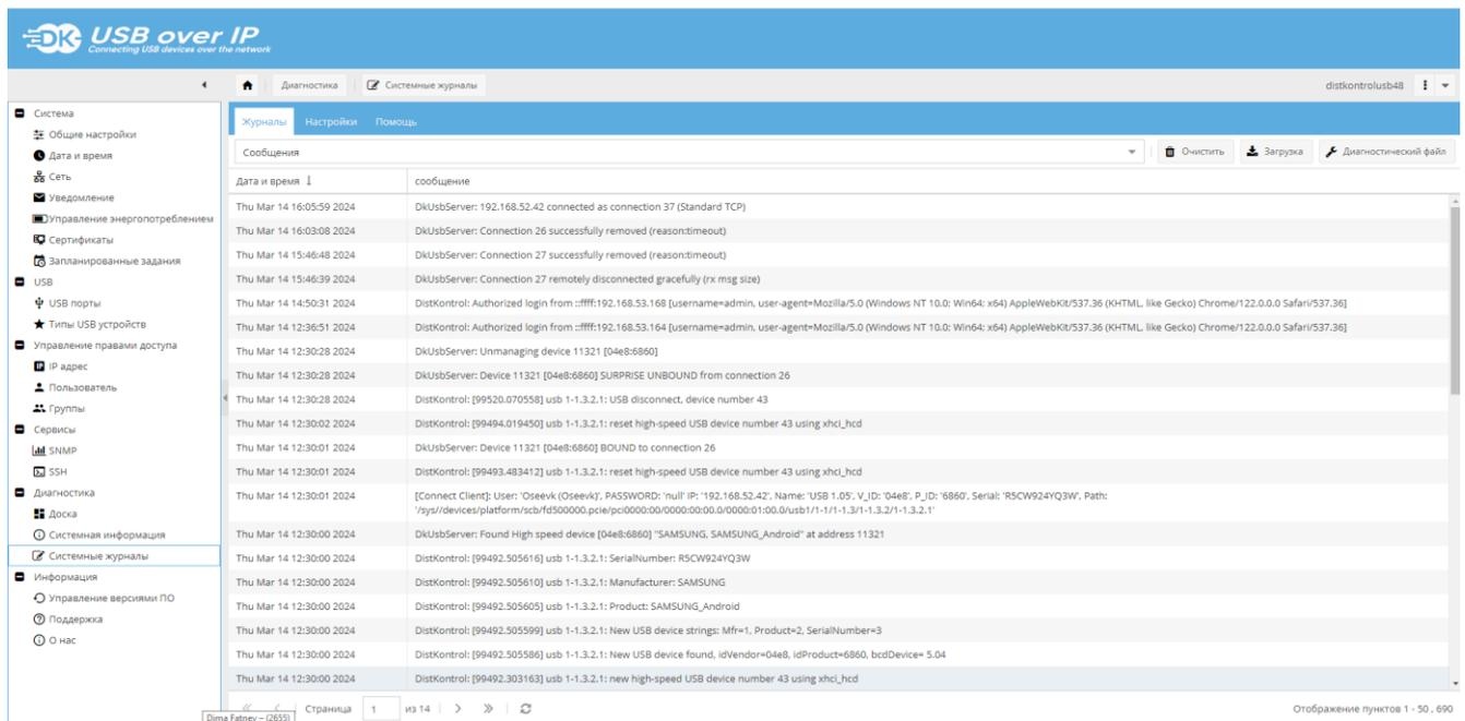
В строке [Connect Client] -> отображаются параметры подключения USB устройства пользователем в следующей последовательности:
