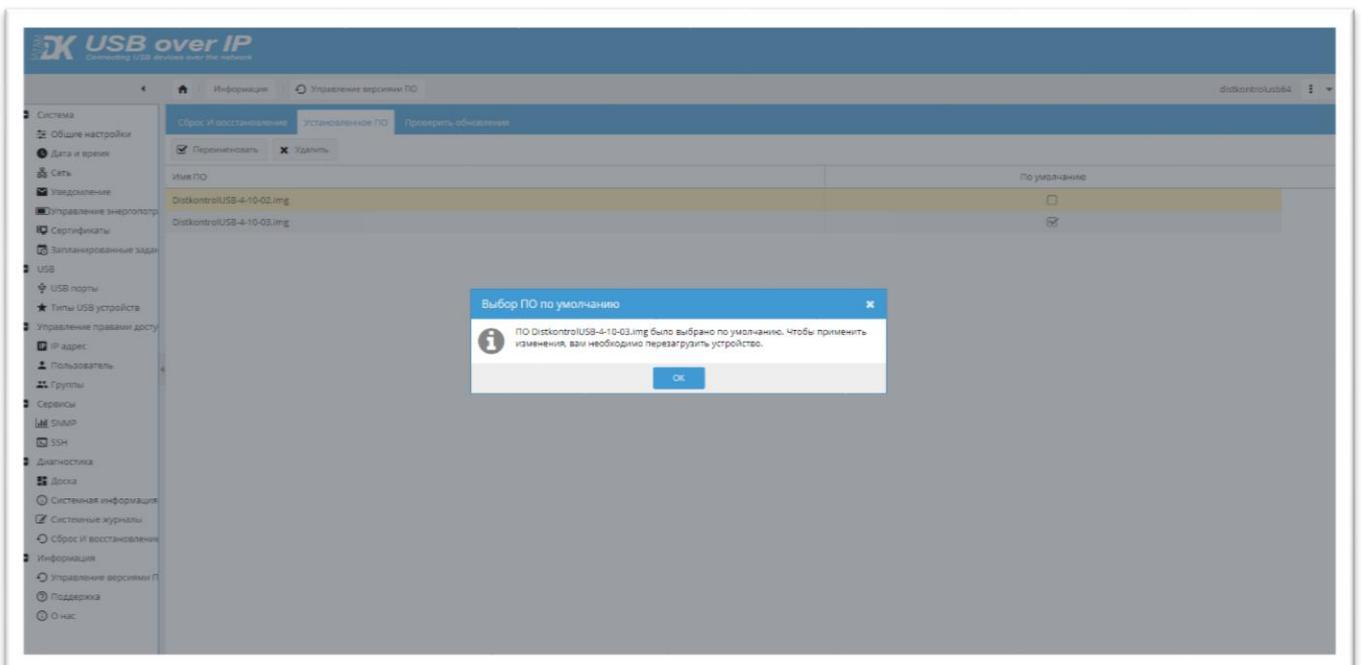
После нажатия на чек-бокс, откроется окно уведомления, информирующее о том, что ПО выбрано по умолчанию и концентратор необходимо перезагрузить. Перезагрузить устройство возможно: через Web-интерфейс или с помощью аппаратного тумблера на тыльной стороне концентратора.
