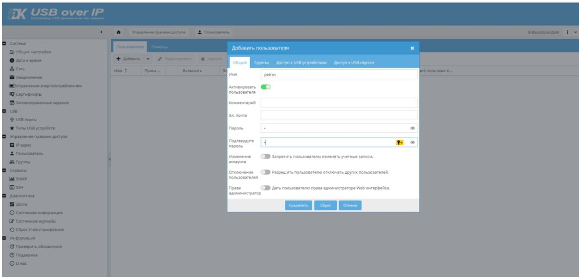
Имена пользователей должны **СОВПАДАТЬ** с системным именем пользователя (имя текущего пользователя компьютера, с которого производится подключение к USB - устройству). При необходимости его так же можно посмотреть (после попытки подключения к USB - устройству) в системном журнале. См. пример выше. Email и пароль пользователя – любые. Рекомендуется использовать сложные пароли.
