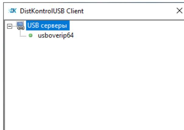
При подключении к USB over IP USB устройств они будут видны в клиенте и их будет можно подключить к компьютеру:
