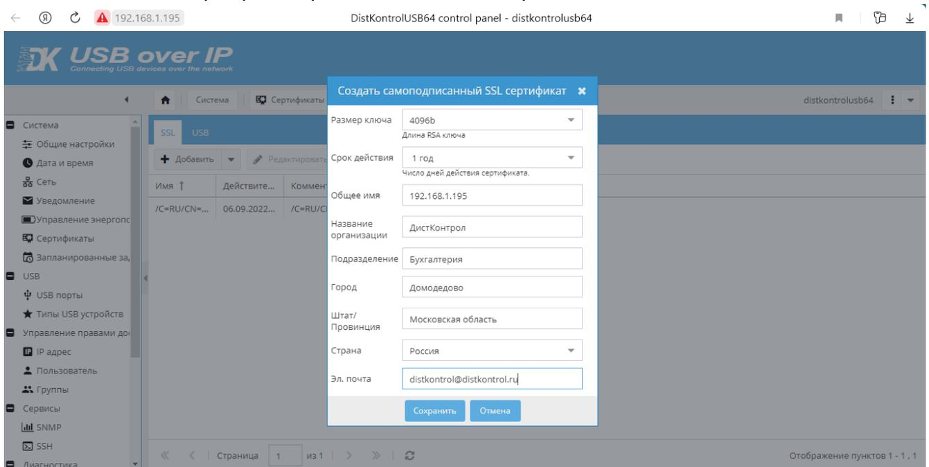
Безопасное соединение для WEB - интерфейса можно включить на странице «Общие настройки». Там же можно включить принудительное использование только безопасного соединения для доступа к WEB - интерфейсу управляемого USB over IP концентратора.
